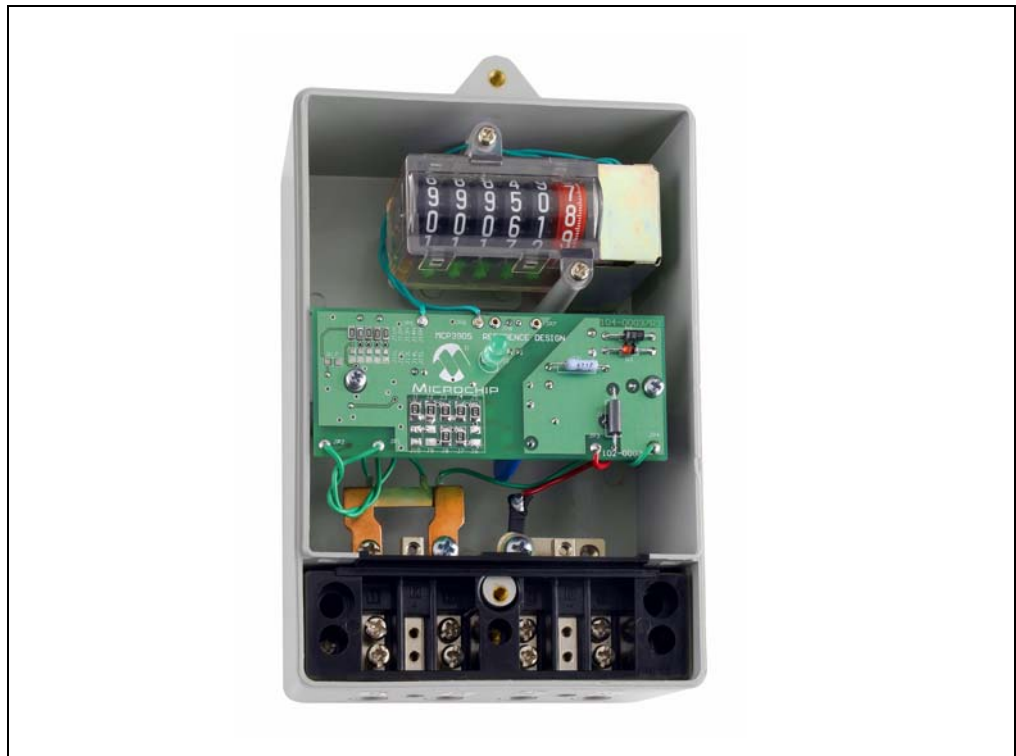
图 2-2: 完整的独立 MCP3905 电能表的照片
